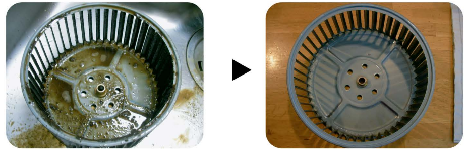
キッチンの換気扇 シロッコファン
