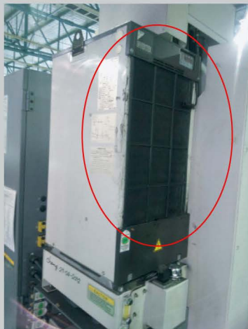
工作機械メーカーに多く採用 されているオイルチューナー のコンデンサ汚れ
